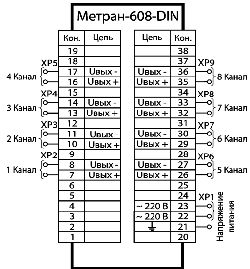
Рис.7. Схема подключения блоков Метран-608 (исполнение DIN).
